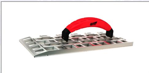
Schleifraspel mit Grundkörper aus hochwertigem, verschleißfestem Edelstahl (Speziallegierung, rostfrei) mit hoher Zähigkeit. Scharfkantige Verzahnung der Arbeitsfläche mit 12 x 5 Zahnreihen, robuste und solide Konstruktion auf U-Profil-Basis mit Material-Durchlassöffnungen. Eine Stirnseite "verjüngt" zur Erreichung schwer zugänglicher Arbeitsbereiche, ergonomisch geformter, schlagfester 2-Komponenten-Griff
