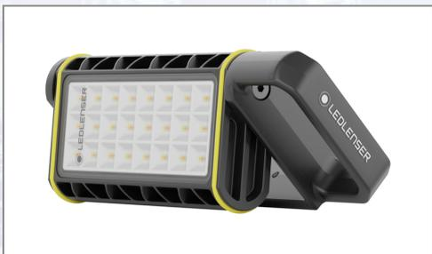
Kompaktes und leuchtstarkes Area Light mit bis zu 2000 Lumen, 5 Helligkeitsstufen und 5-stufig einstellbarer Farbtemperatur. Effizientes gerichtetes Licht, maximale Beleuchtungsstärke und weniger Blendeffekte durch Multi-Concentrated Light. Hybrid Power: leistungsstarker aufladbarer Akku sowie kabelgebundener Betrieb. Hoher Staub- und Wasserschutz (IP 67), robustes Aluminiumgehäuse und flexible Anbringungsmöglichkeiten. Technische Daten: -
